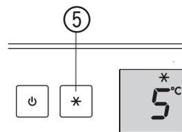
**Внимание:** При нажатии кнопки быстрого замораживания Superfrost из-за установленного времени задержки включения компрессор может включиться с задержкой до 8 минут. Эта задержка повышает срок службы холодильной установки.
