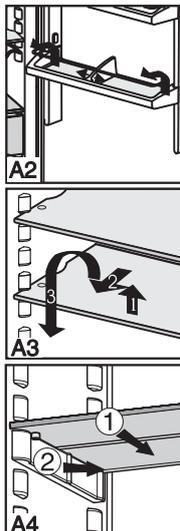
**Рис. A4.** Если требуется место для высоких бутылок и емкостей, то достаточно просто сдвинуть назад переднюю половину стеклянной пластины ①. Для чистки можно снимать крепежные элементы ② половинок стеклянных пластин.
