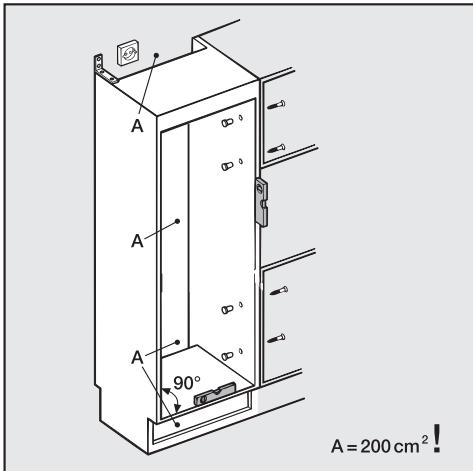
Перед встраиванием прибора следует выполнить тщательное выравнивание мебельного шкафа с помощью ватерпаса. Все углы шкафа должны составлять 90°. Отрегулируйте дверцы шкафа с помощью шарнирных петель.
