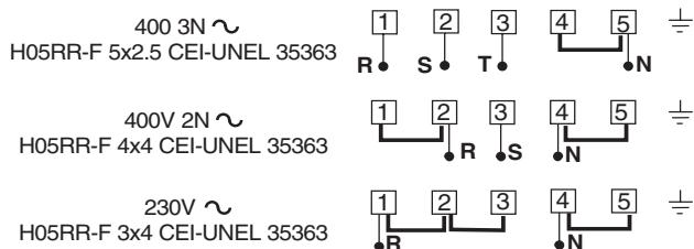
Порядок подсоединения кабеля электропитания:
