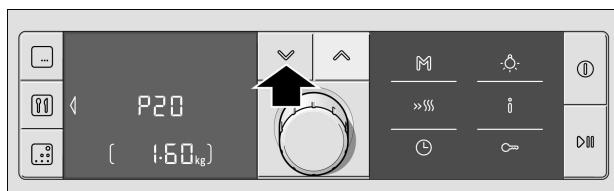
**4.** С помощью поворотного переключателя установите нужный вес блюда.
