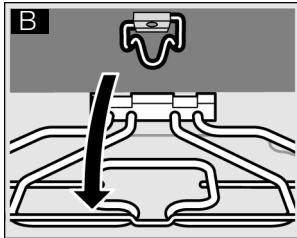
После окончания очистки снова закрепите нагревательный элемент гриля вверху. Нажмите на зажим гриля и вставьте нагревательный элемент на место.
