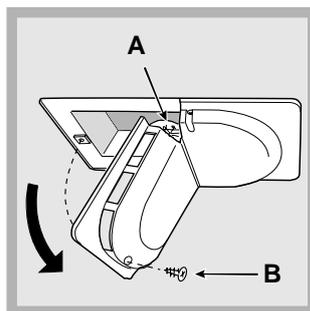
Отвинтите крепежный винт (B), расположенный в задней части плафона, откройте плафон с лампочкой (A), как показано на рисунке (см. рисунок). Замените лампочку на новую такого же типа мощностью не более 15 Вт.
