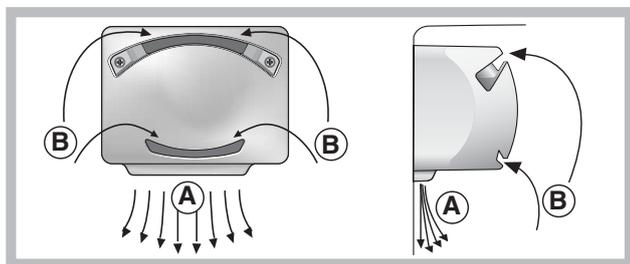
Система PURE WIND PLUS гарантирует отличную сохранность продуктов благодаря быстрому восстановлению заданной температуры после открывания двери и обеспечивает однородную температуру во всей холодильной камере: Нагретаемый воздух (А) охлаждается, поступая в контакт с холодной стенкой камеры, в то время как более теплый воздух (В) высасывается из камеры (см. рисунок).
