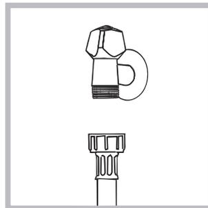
1. Прикрутите шланг подачи к крану холодной воды с резьбовым отверстием 3/4 gas (см. схему).
