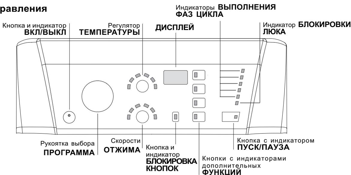
**Кнопка и индикатор ВКЛ/ВЫКЛ:** служит для включения и выключения машины. Горящий индикатор показывает, что машина включена.
