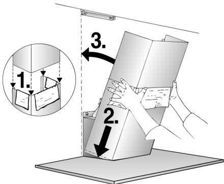
14. Осторожно выдвигните верхнюю секцию обшивки вытяжной трубы вверх и с боков привинтите двумя винтами к уголку.
