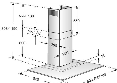
**⚠** Полный комплект для монтажа можно приобрести в **специализированном магазине**. Соответствующие номера принадлежностей можно найти в инструкции по эксплуатации.
