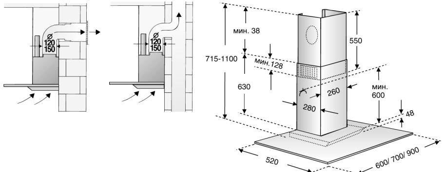
Отводимый воздух подается вверх через вентиляционную шахту или непосредственно через наружную стену за пределы помещения.
