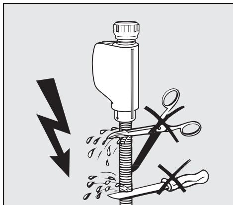
**⚠** Заливной шланг **нельзя** укорачивать или повреждать, так как в нем имеются токоведущие детали (см. рисунок).
