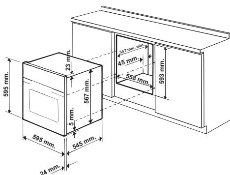
! После встраивания изделия в кухонный элемент должна быть исключена возможность касания к электрическими частями.
