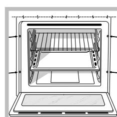
Для крепления изделия к кухонному элементу: откройте дверцу духового шкафа и завинтите 4 шурупа для деревянных панелей в 4 отверстия в периметральной раме.
