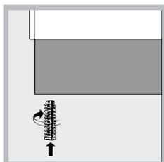
При необходимости выровнять изделие вкрутите в специальные отверстия по углам в основании кухонной плиты прилагающиеся регуляционные ножки\* по (см. рисунок).
