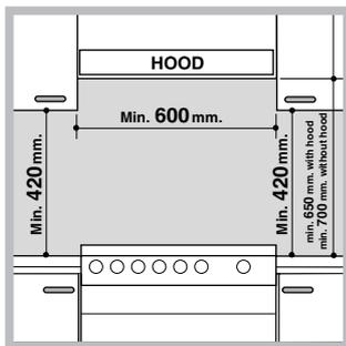
• если кухонная плита устанавливается под навесным шкафом, он должен располагаться на высоте не менее 420 мм от поверхности варочной панели. Это расстояние должно быть 700 мм, если навесные шкафы выполнены из возгораемого материала (см. рисунок);
