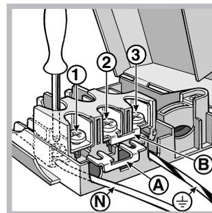
2. установите соединительную перемычку A (см. рисунок) по приведенной выше электрической схеме. Зажимная коробка рассчитана на монофазное соединение 230 В: зажимы 1, 2 и 3
