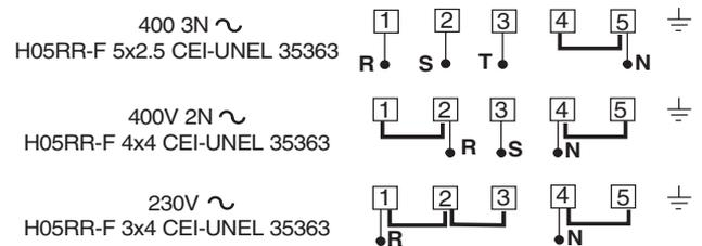
Порядок подсоединения кабеля электропитания:
