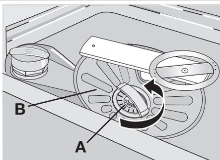
2. Фильтр (А) состоит из двух частей. Для разборки фильтра разъедините эти части.
