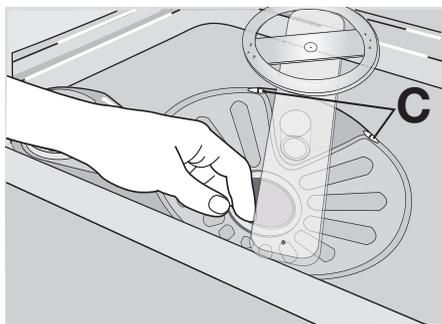
8. Установите фильтр (А) в фильтр (В) и поверните его по часовой стрелке до щелчка.
