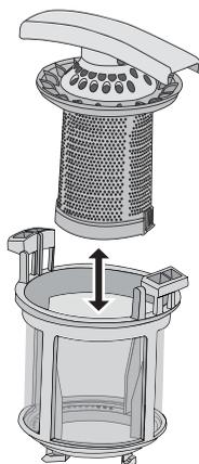
3. Тщательно промойте элементы фильтра в проточной воде.
