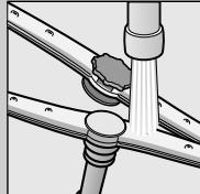
промойте отверстия в проточной воде (при необходимости воспользуйтесь зубочисткой) ...
