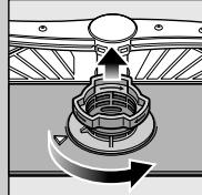
Поверните цилиндрический фильтр, извлеките фильтрующую систему ...
