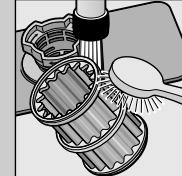
промойте ее в проточной воде ...
