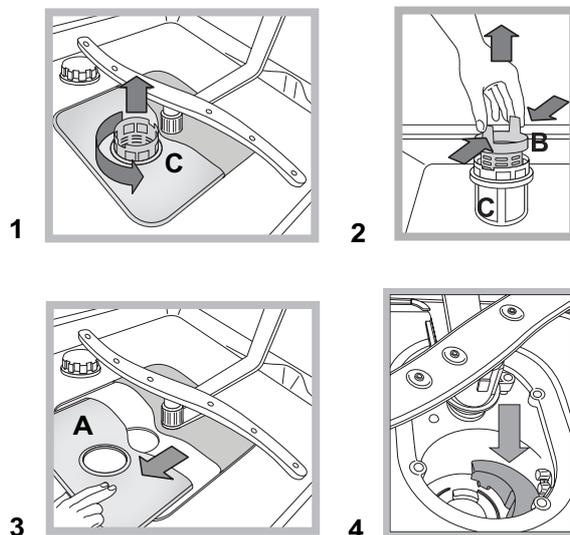
После чистки фильтров точно установите фильтрующий узел на свое место, что является важным для исправной работы посудомоечной машины.
