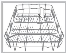
Некоторые модели посудомоечных машин укомплектованы откидными подставками\*, которые можно также использовать в вертикальном положении для размещения тарелок или же в горизонтальном для размещения
