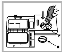
1. Откройте дозатор, повернув крышку (G) против часовой стрелки.
