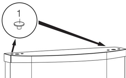
7. Отвинтите поворотный штифт верхней петли (t1) и привинтите на противоположной стороне.
