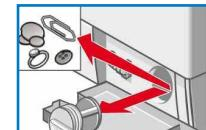
4. Очистите внутреннее пространство, резьбу крышки насоса и сам корпус насоса (крыльчатка насоса должна свободно вращаться).
