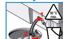
3. Осторожно отверните крышку насоса (остаточная вода!).
