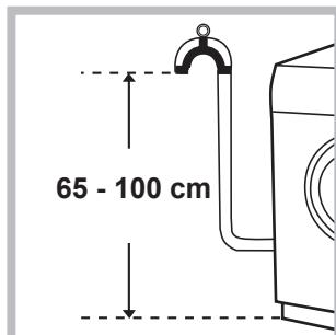
Повесьте загнутый конец сливного шланга на край раковины, ванны, или поместите в специальный вывод канализации. Шланг не должен перегибаться. Верхняя точка сливного шланга должна находиться на высоте 65-100 см от пола. Расположение сливного шланга должно обеспечивать разрыв струи при сливе (конец шланга не должен быть опущен в воду). В случае крепления на край ванной или раковины, шланг вешается с помощью направляющей (входит в комплект поставки), которая крепится к крану (рис.).
