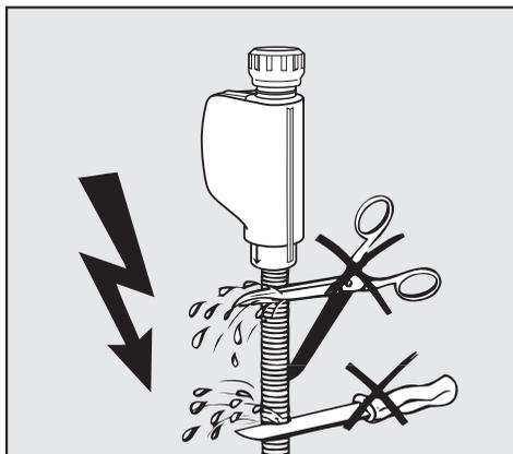
**⚠** Заливной шланг **нельзя** укорачивать или повреждать, так как в нем имеются токоведущие детали (см. рисунок).
