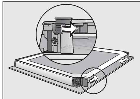
■ Закройте стопоры дверных панелей, повернув их внутрь.
