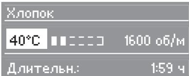
С помощью кнопки **V** температура может быть понижена и с помощью кнопки **A** повышена.
