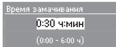
■ Выберите желаемое время замачивания с помощью кнопки  $\vee$  или  $\wedge$  и подтвердите с помощью кнопки OK.
