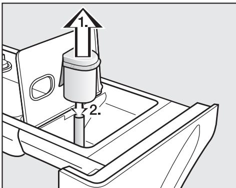
1. Вытяните сифон из ячейки ⚙ и промойте под струей теплой воды. Также вымойте трубку, на которой находится сифон.
