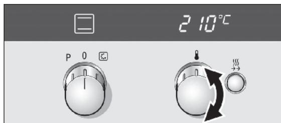
6. Теперь, при необходимости, задайте мощность микроволн. Нажмите кнопку «Микроволны» и установите нужную мощность с помощью поворотного переключателя.
