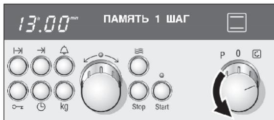
5. Установите температуру или режим гриля с помощью регулятора температуры.
