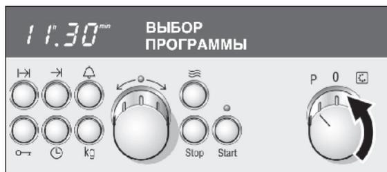
**3.** С помощью поворотного переключателя установите нужную программу. Поверните поворотный переключатель вправо – на дисплее в возрастающем порядке, начиная с 01, начнут появляться номера программ. Поверните поворотный переключатель влево – на дисплее появляется «ПАМЯТЬ», а затем номера программ в убывающем порядке.
