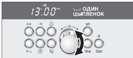
Раздается сигнал. Вы можете выключить сигнал, нажав кнопку «Стоп». На текстовом дисплее появится 0 и сообщение «ПРИЯТНОГО АППЕТИТА». Выключите ручку выбора функций.
