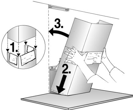
14. Осторожно выдвиньте верхнюю секцию обшивки вытяжной трубы вверх и с боков привинтите двумя винтами к уголку.
