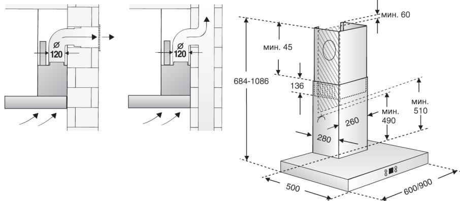
Отводимый воздух подается вверх через вентиляционную шахту или непосредственно через наружную стену за пределы помещения.
