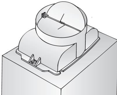
**⚠** Должна быть возможность сдвигать вверх два клапана с небольшим подпружиниванием.
