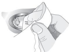
**Примечание.** При установке галогенной лампы не следует прикасаться к ее стеклянной колбе. При установке берите лампу чистой тряпкой.
