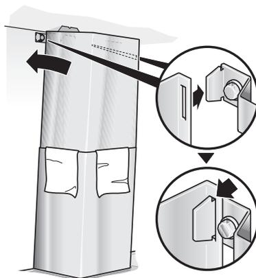
5. Двумя винтами привинтите внутреннюю секцию обшивки вытяжной трубы с боковых сторон к крепежной скобе.
