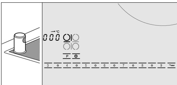
4. В течение следующих 10 секунд установите в зоне настроек требуемую температуру. Вы можете установить температуру от 60 до 180 °С. Если вы установите другую температуру, прозвучит сигнал и команда будет проигнорирована.
