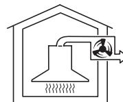
У кухонной вытяжки, которая подготовлена для эксплуатации с использованием выносного двигателя, всасывающий вентилятор устанавливается снаружи помещения в удобном для Вас месте.
