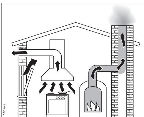
Этого можно добиться, если с помощью постоянных отверстий, например, незакрывающихся форточек в дверях и окнах, обеспечить дополнительное поступление воздуха, необходимого для горения.
