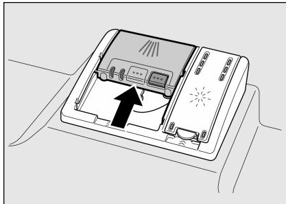
Ячейка с моющим средством открывается автоматически в зависимости от выбранной программы в самый подходящий для этого момента времени. Порошкообразное или жидкое моющее средство распределяется внутри машины и затем растворяется, таблетка падает в предназначенную для нее подставку и, находясь в ней, постепенно растворяется.
