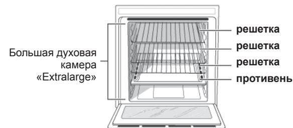
! Перед первым использованием в течение получаса прокалите пустую духовку с закрытой дверцей при максимальной температуре. Прежде чем выключить оборудование и открыть дверцу, удостоверьтесь в наличии хорошей вентиляции в помещении. Появившийся во время прокаливания неприятный запах вызван сгоранием защитных веществ, используемых во время производства оборудования.
