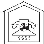
Всасываемый воздух очищается, проходя через решетку и жироулавливающий фильтр, и дополнительно с помощью **угольного фильтра**. Через отверстия в телескопической трубе вытяжки воздух попадает обратно в кухню.
