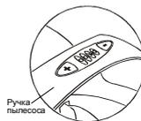
Установленный на данный момент уровень мощности всасывания отображается свечением одного из четырех индикаторов.
