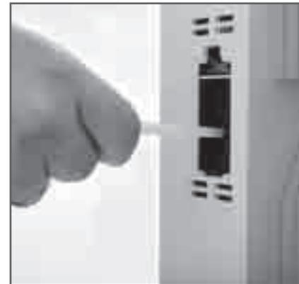
2. Откройте крышку датчика, которая находится с правой стороны устройства. Протрите влажным ватным тампоном линзы и отверстия входа и выхода воздуха. Остатки влаги удалите сухим тампоном.
