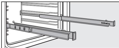
Телескопические направляющие FlexiClip можно закрепить на каждом ярусе загрузки и полностью выдвигать из рабочей камеры. Они обеспечивают оптимальный обзор приготавливаемого блюда.
