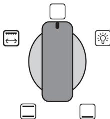
Рис. 3. Переключатель режимов работы духового шкафа IES 1624/1.
