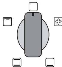
Рис. 4.1 переключатель режимов работы духового шкафа IES 1654
