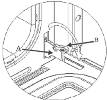
Для облегчения чистки Вы можете снять дверь духовки (см. рис. 6). Петли А оборудованы фиксаторами В. Оба рычага фиксаторов В поднимите до упора как
