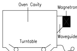
В микроволновой печи электричество преобразовано в микроволну с помощью МАГНЕТРОНА
