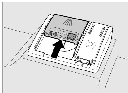
Ячейка с моющим средством открывается автоматически в зависимости от выбранной программы в самый подходящий для этого момента времени. Порошкообразное или жидкое моющее средство распределяется внутри машины и затем растворяется, таблетка падает в предназначенную для нее подставку и, находясь в ней, постепенно растворяется.
