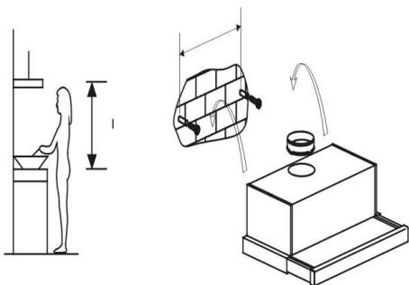
соответствующем месте 2 отверстия диаметром 8 мм так, чтобы отверстие на задней стене кухонной вытяжки было посередине между ними.
