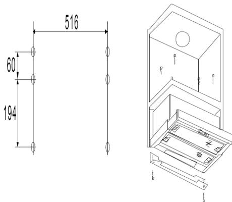
этого разместите кухонную вытяжку на нижнюю часть настенного шкафа и прикрепите ее при помощи шести прилагаемых винтов.
