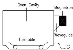
В микроволновой печи электричество преобразовано в микроволны с помощью МАГНЕТРОНА
