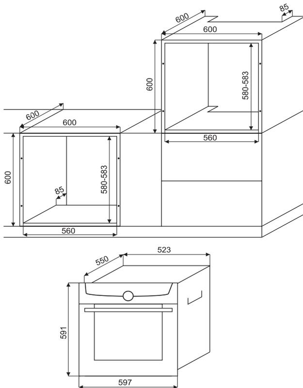
Рис. 7. Схема по встраиванию духового шкафа
