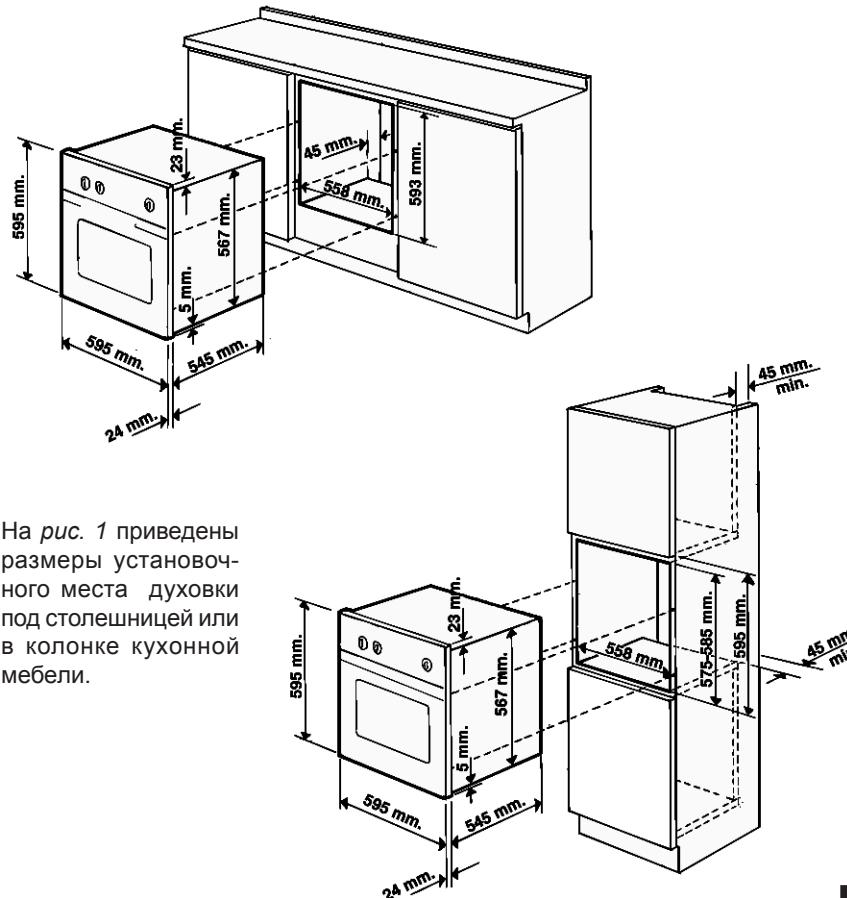
На рис. 1 приведены размеры установочного места духовки под столешницей или в колонке кухонной мебели.
