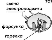
\* Форсунка маркируется в сотых долях мм в соответствии с диаметром ее проходного сечения
