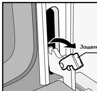
2. Оттяните защелки, расположенные на петлях по обеим сторонам дверцы до положения, при котором они упрутся в штыри.
