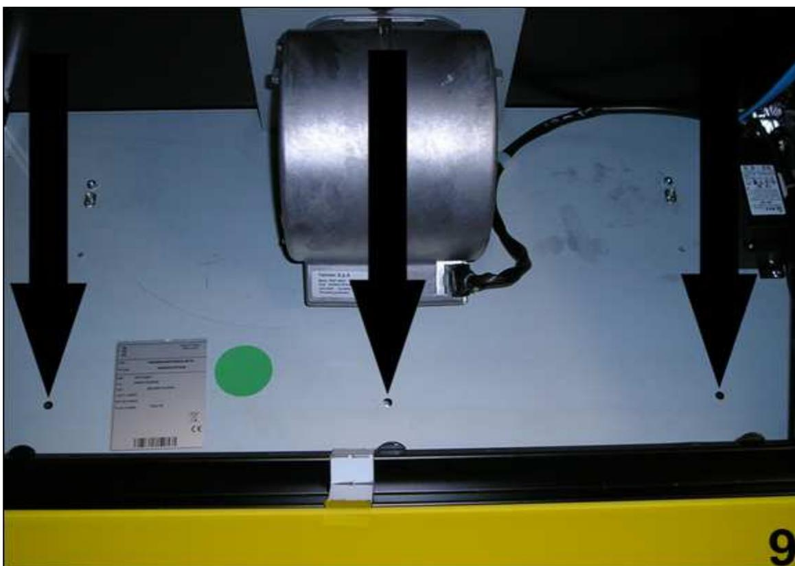
9. С внутреннего пространства вытяжного шкафа потом обозначьте расположение трех нижних отверстий, которые сейчас необходимо просверлить.
