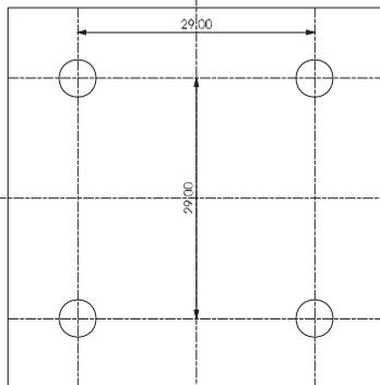
Вы можете вырезать и использовать эту схему в качестве трафарета. Размеры указаны в миллиметрах.
