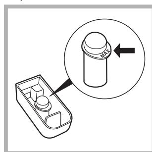
Лоток 4 для отбелителя вставляется в отделение 1 распределителя моющих средств. Не заполняйте лоток 4 выше отметки max (см. рис.).
