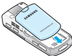
2. Нажмите на аккумулятор для его надежной фиксации.
