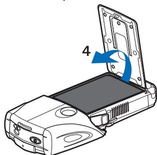
4 — Извлеките аккумулятор из отсека.
