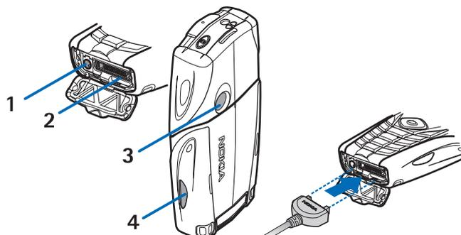
1 — Разъем для подключения зарядного устройства
