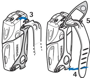
3 — Вставьте штифт на другом конце оправки в отверстие в верхней части телефона.
