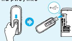
2. Подключение к ПК через USB-кабель. Схема подключения плеера через USB-кабель прилагается
