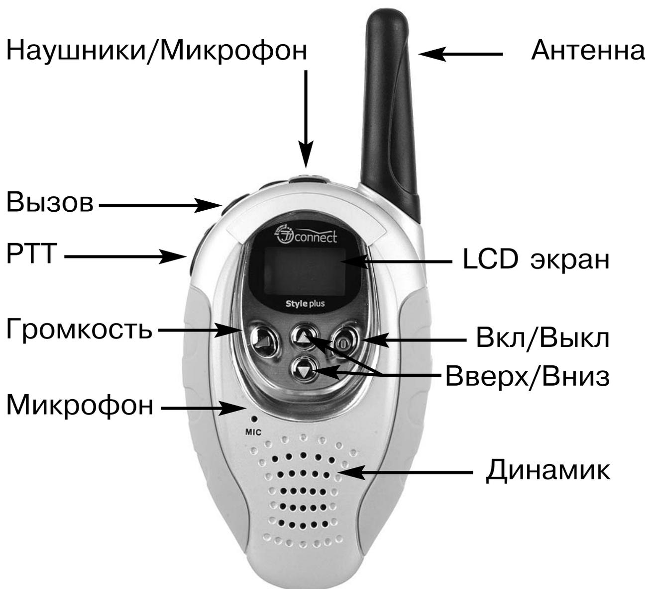
**Схема расположения кнопок**
