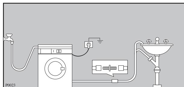
Другой конец наливного шланга, подключающийся к машине, может быть повернут в любом направлении. Ослабьте гайку, поверните шланг и вновь затяните гайку, проверив отсутствие течей воды. Наливной шланг нельзя вытягивать. Если он слишком короткий, и вы не хотите передвигать кран, то вам следует купить новый, более длинный, специально предназначенный для данных целей.
