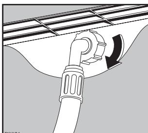
Нельзя перегибать сливной шланг. Он должен пролегать по полу и подниматься только рядом со сливной трубой.
