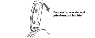
**2** Vložte jednu batériu typu R03 (veľkosť AAA), pričom dbajte, aby značky **+** a **−** na batérii zodpovedali značkám **+** a **−** v priestore pre batérie.
