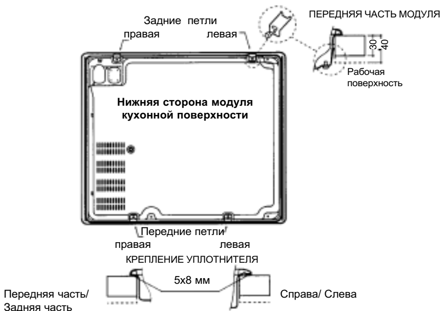
Монтаж нижней части оборудования
