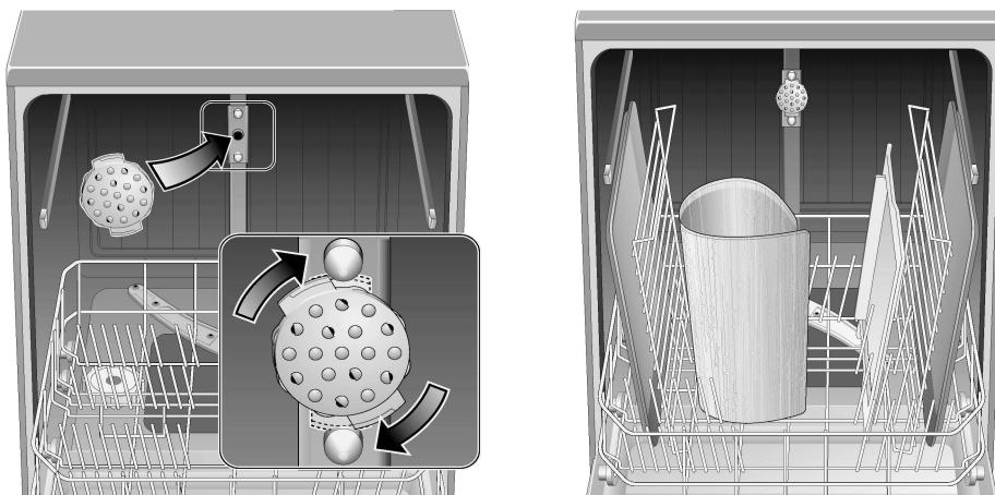
С помощью этой разбрзгивающей головки Вы можете помыть большие противни или решетки, а также тарелки диаметром более 30 см (тарелки для гурманов, тарелки для спагетти, тарелки-подставки).
